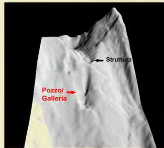
Esempi di imbocchi individuati utilizzando la visione 3D del DTM LiDAR (lungo il costone di Staviòn e sulla Cima Boai)
